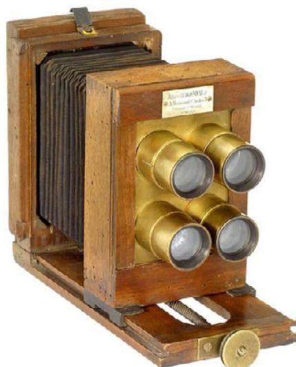
Disderi ajustó un tipo especial de cámara provista de cuatro lentes que operaban simultáneamente o en una sucesión rápida.
